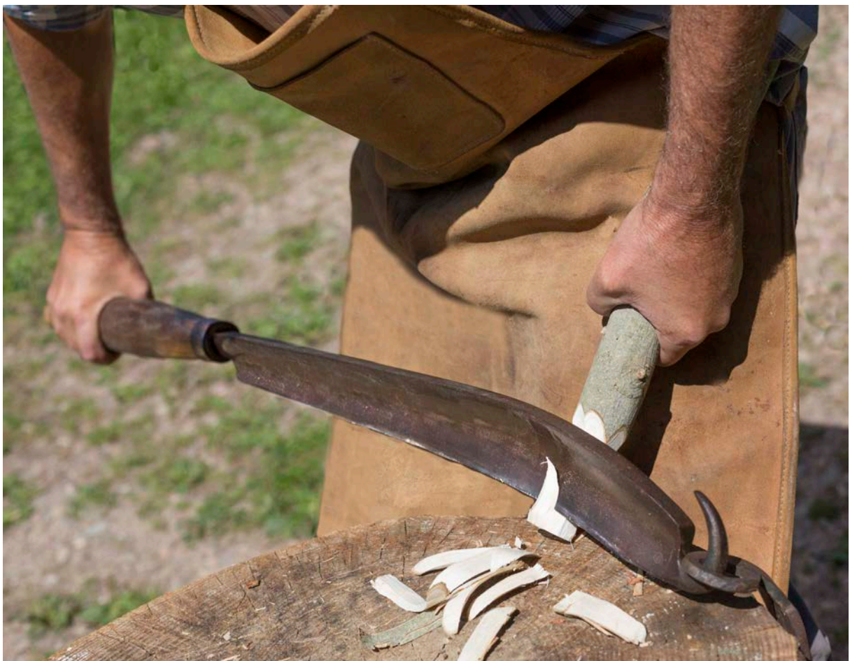
Un paroir de sabotier en action. La longueur du bras de levier donne beaucoup de puissance.
